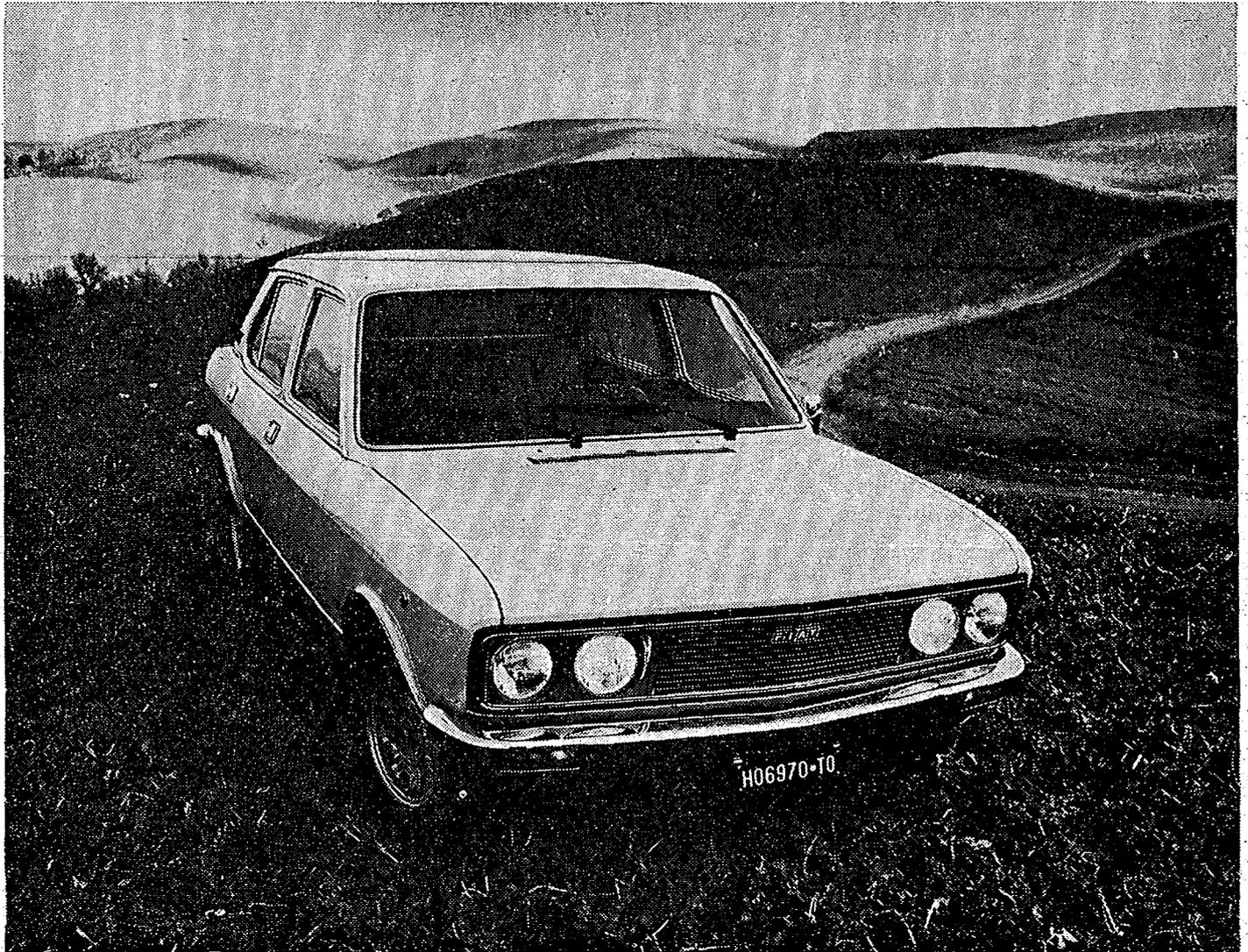
*La Fiat 132 è disponibile in tre versioni con due motori a doppio albero a camme in testa: un "1600" da 98 CV (DIN) e un "1800" da 105 CV (DIN). Velocità 165 e 170 km/h.*
